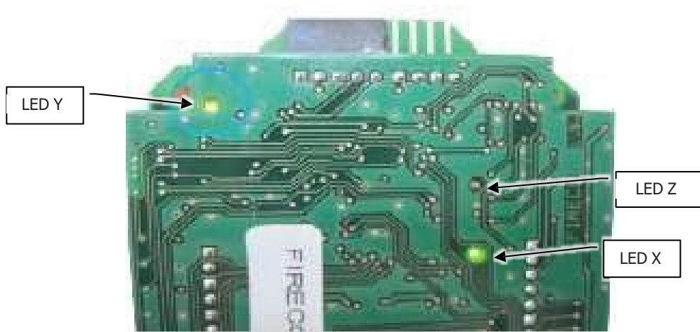
5-4.5. attēls: Elektroniskās plates LED indikators
